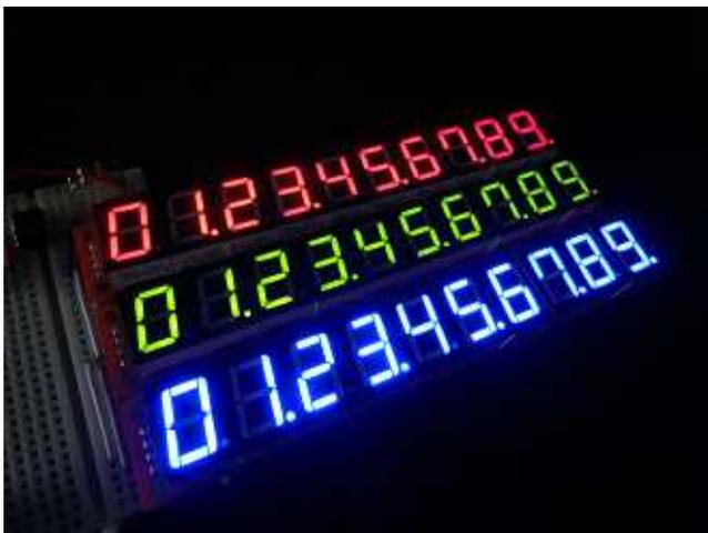
下図は、20MHz 駆動の PIC12F675 (8pinPIC) で、リアルタイムに3つのモジュールを高速表示更新しているデモです。動画で見ないと判りづらいですが、上段はカスタムビット点灯デモ、中段は輝度制御デモ、下段は高速更新のデモです。(全て8に見えますが、0123456789 を高速スクロールしています)
